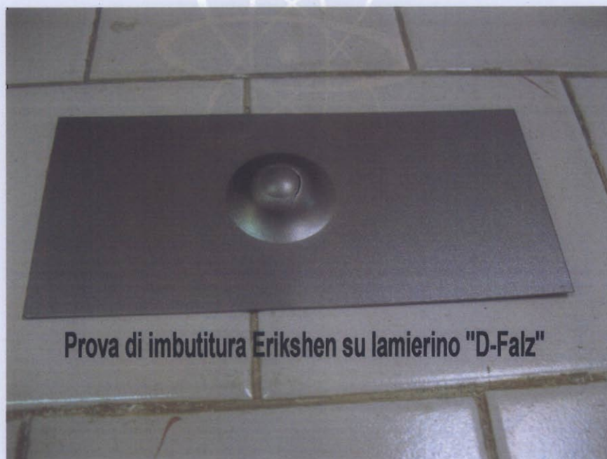
Fotografia del campione dopo la prova di imbutitura Erikshen.
