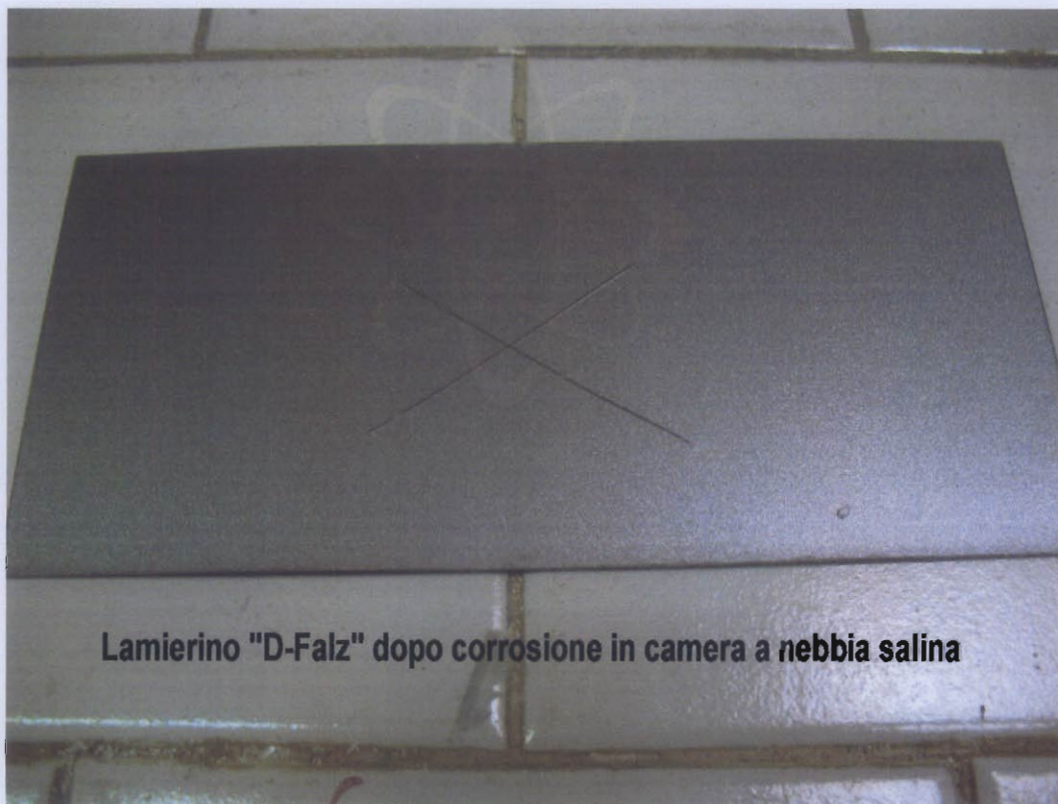
Fotografia del campione dopo la prova di corrosione in camera a nebbia salina.
